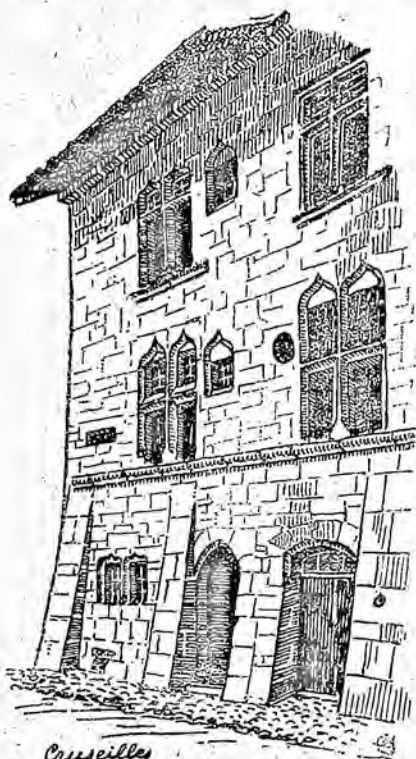
Partie de la façade d'un Château savoyard. Cette demeure est à deux étages, dans lesquels s'ouvrent d'abord la porte basse cintrée de robustes contreforts, puis les baies jumelées à meneaux et accolades, montrant le rapport des pleins et des vides.
