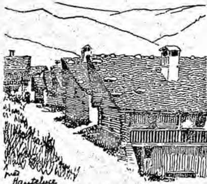
Pittoresque succession de Chalets en montagne, avec leurs cheminées gentiment coiffées, leur galerie sous l'avant-toit qui dessert le premier étage et les grosses pierres qui chargent le toit pour diminuer la prise du vent.
