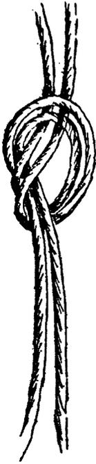
FIG. 37. — Exécution d'un nœud pour accoupler les fuseaux.
