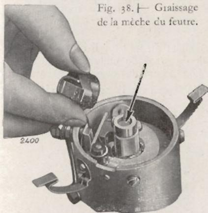
Fig. 38. — Graissage de la mèche du feutre.
