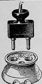
N° 4585. Bipolaire, 3 ampères. PRISES DE COURANT de fil souple, 110 et 220 volts, fond porcelaine blanche, bouchon ébénite (bois durci à brèches fondues pour 10 et 30 ampères).
