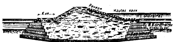
Fig. 7. — Méthode employée pour la construction de la digue à travers le lac Y. Coupe transversale de cette digue.
