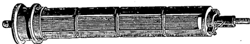
Fig. 47. — Armature Siemens.
