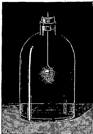
Fig. 33. — Combustion du diamant dans l'oxygène.
