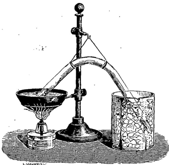
Fig. 82. — Liquéfaction des gaz par le procédé de Faraday et Davy.
