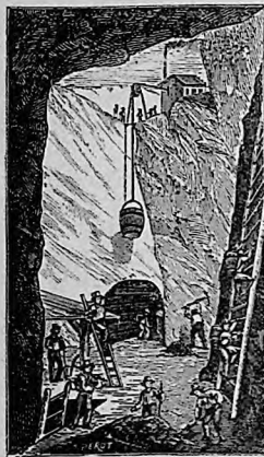
UNE MINE DE FER. — Le fer est le plus utile des métaux, c'est aussi celui dont la France est le plus riche. Il se trouve le plus souvent dans la terre sous forme de rouille. Les mineurs le détachent à coups de pic, et on le fait fondre ensuite dans les hauts fourneaux pour le purifier.
