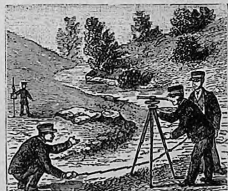
INGÉNIEURS DES PONTS ET CHAUSSÉES LEVANT UN PLAN. — L'ingénieur placé à droite mesure l'élévation du terrain à l'aide d'un instrument appelé niveau. Pour cela il recourt à travers cet instrument la mire qu'il tient l'homme placé dans le fond. Celui qui est penché vers la terre mesure la superficie du terrain à l'aide d'une longue chaîne dite chaîne d'arpenteur.
