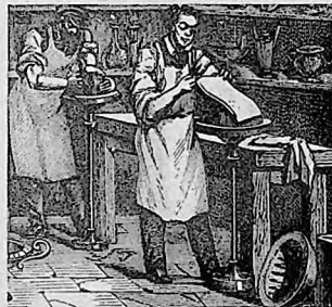
OUVRIER FABRIQUANT DE LA PORCELAINE. — La porcelaine se fabrique avec une terre très fine, le kaolin, qu'on réunit en pâte. Ensuite on divise cette pâte en feuilles blanches comme des feuilles de papier. L'ouvrier de droite tient une de ces feuilles entre ses mains et va l'appliquer sur le moule pour en faire un saladier. En même temps il fait tourner le moule. L'ouvrier de gauche est plus avancé en besogne. Sa feuille a déjà le forme du moule et il achève de l'appliquer avec une éponge. Il n'y a plus ensuite qu'à faire cuire au four les objets fabriqués.
