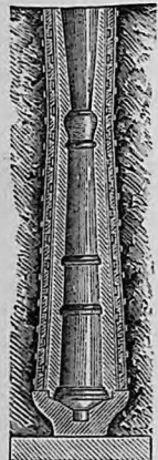
Moule d'un canon. — Ce moule se trouve placé sous terre. On verse dedans le métal fondu ; ensuite, quand le métal est refroidi, on brise le moule : le métal a pris la forme d'un canon.
