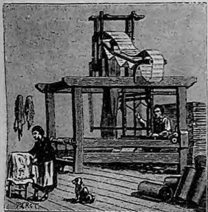
OUVRIER DE LYON TISSANT LA SOIE A L'AIDE DU MÉTIER JACQUARD. — La plupart des ouvriers de Lyon travaillent chez eux avec des métiers qu'ils possèdent ou qu'on leur prête. D'autres travaillent dans de grands ateliers où les métiers sont nus par la vapeur. Du haut des métiers on voit se dérouler toutes faites les pièces de soieries ou de rubans.
